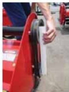
Controleer uitlijning met een liniaal
