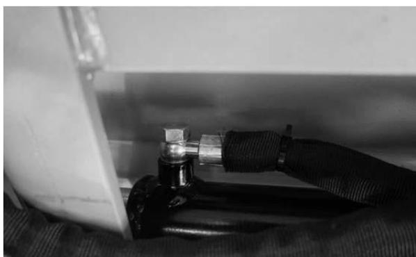
Fig. 16 Conduite hydraulique gauche
