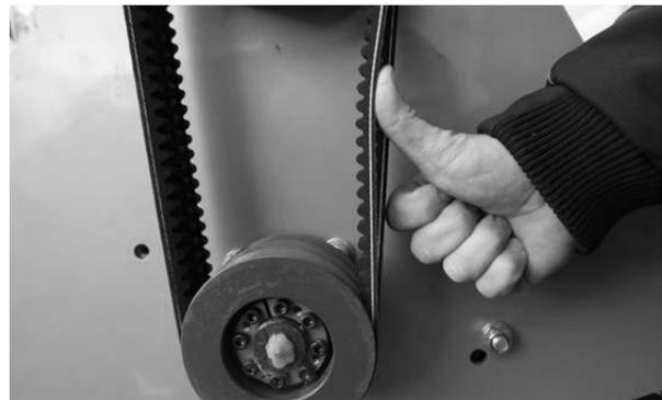
Fig. 26 Tension correcte de la courroie de transmission
