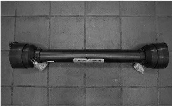
Fig. 41 Prise de force avec protecteur et chaînes
