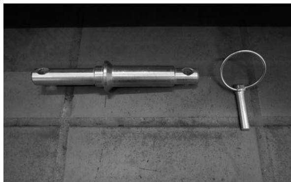
Fig. 39 Tweezijdige bout met borgpen
