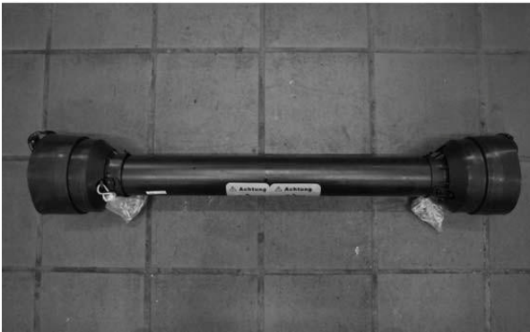
Fig. 41 Aftakas met beschermkap en kettingen
