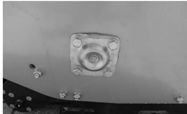
Fig. 32 Smeernippel in rijrichting, rechts
