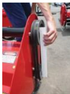
Controleer de verticale uitlijning van de riemschijven met een waterpas. De riemschijven moeten exact zijn uitgelijnd.
