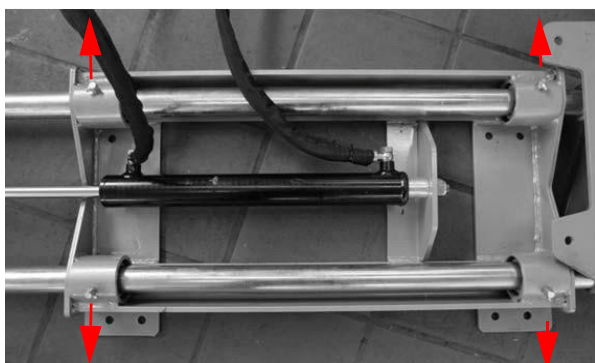
Fig. 11 Onderkant met juist uitgelijnde smeernippels
