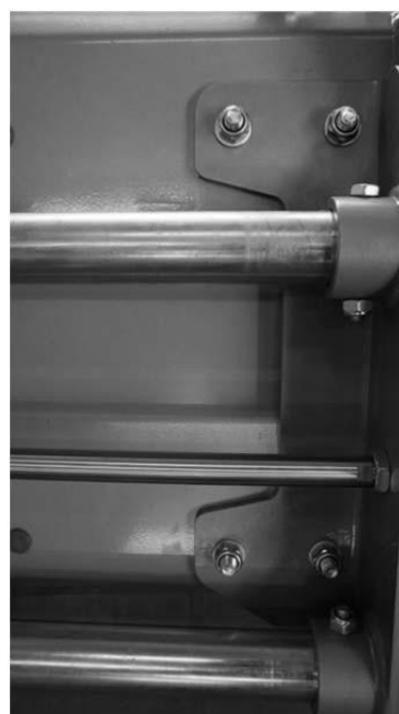
Fig. 15 Bevestigde hydraulische sideshift (rechterkant)
