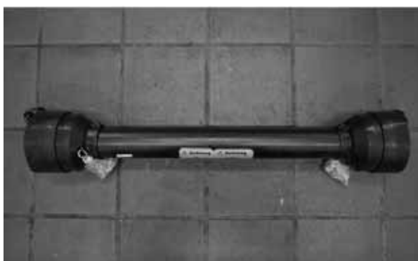
Fig. 41 Prise de force avec protecteur et chaînes
