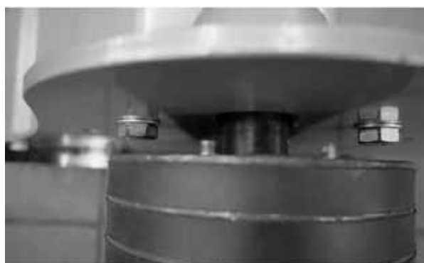
Fig. 25 Distance correcte de l'arbre de transmission
