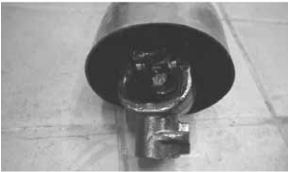
Fig. 33 Graisseur sur la prise de force
