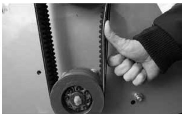
Fig. 26 Tension correcte de la courroie de transmission
