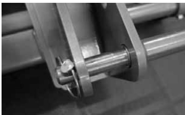
Fig. 40 Vis réversible montée avec goupille de retenue
