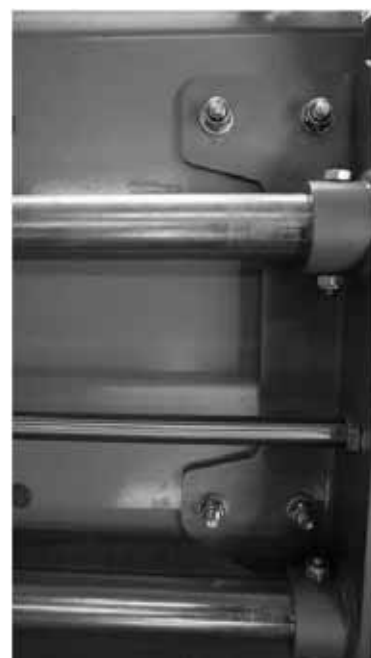
Fig. 15 Pièce hydraulique de décalage latéral montée (côté droit)
