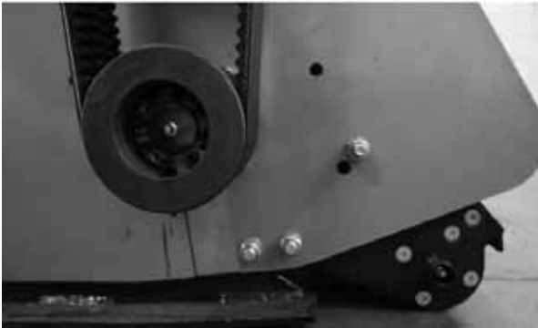
Fig. 31 Graisseur à gauche dans le sens de la marche
