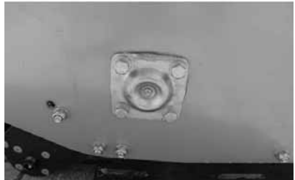
Fig. 32 Graisseur à droite dans le sens de la marche
