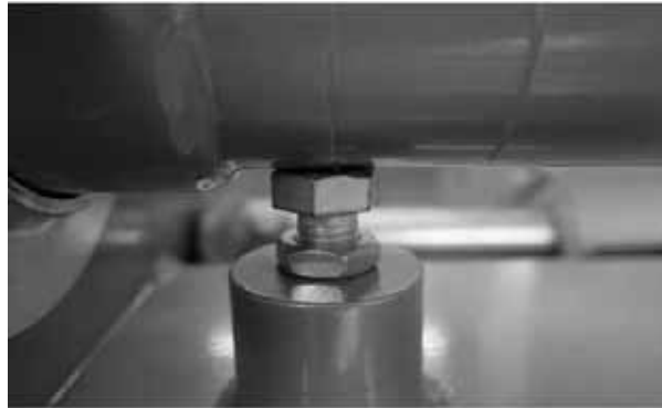
Fig. 21 Dispositif de tension de courroie
