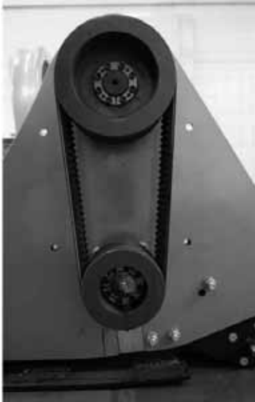
Abb. 35 Bohrungen für Abdeckhaube
