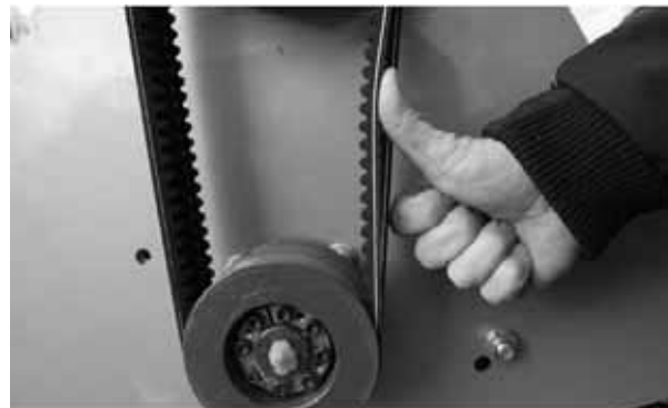
Abb. 26 Korrekte Spannung der Antriebsriemen
