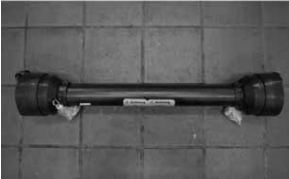
Abb.41 Zapfwelle mit Zapfwellenschutz und Ketten
