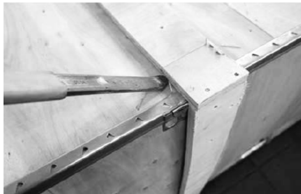
Abb. 2 Ansetzen des Hebels
