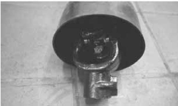
Abb. 33 Schmiernippel an der Zapfwelle
