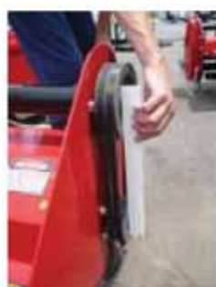
Mit einer Wasserwaage die vertikale Ausrichtung der Riemenscheiben prüfen. Die Riemenscheiben müssen absolut parallel laufen.
