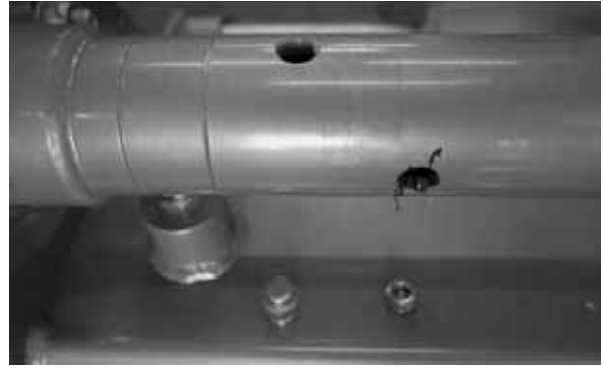
Abb.30 Antriebswelle mit Kontrollöffnung und Einfüllöffnung
