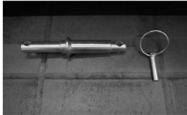
Abb. 39 Wendebolzen mit Sicherungssplint
