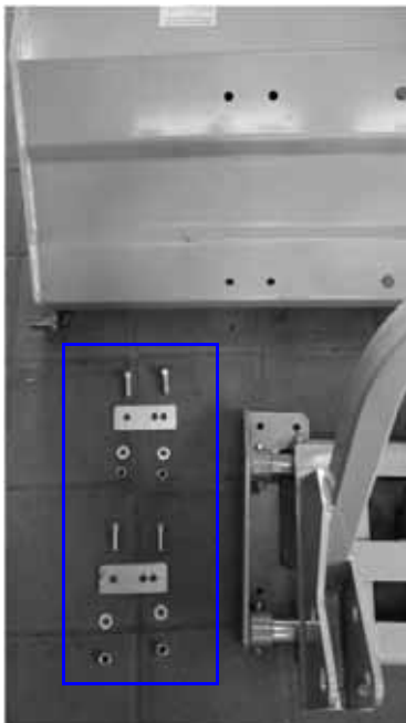
Fig. 14 Bevestigingsmateriaal voor hydraulische sideshift (linkerkant)
