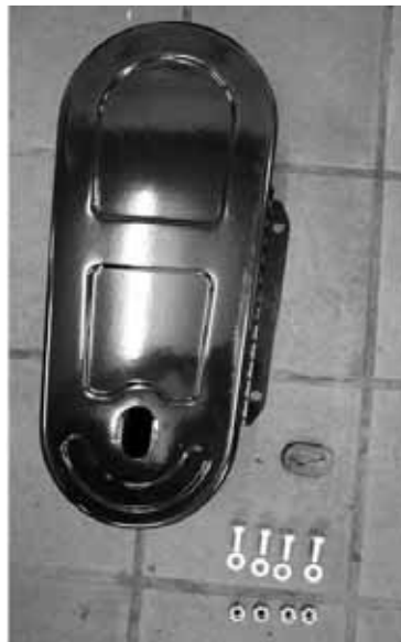
Fig. 36 Beschermkap met bevestigingsmateriaal
