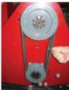
Maximale doorbuiging van 10 mm.
