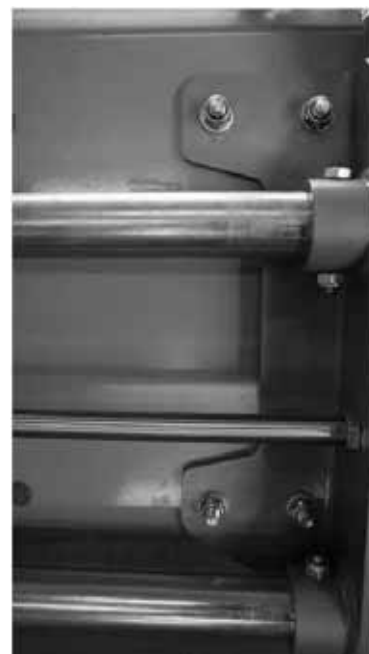
Fig. 15 Bevestigde hydraulische sideshift (rechterkant)
