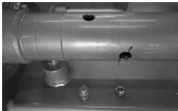
Fig. 30 Aandrijfas met inspectie- en smeeroening
