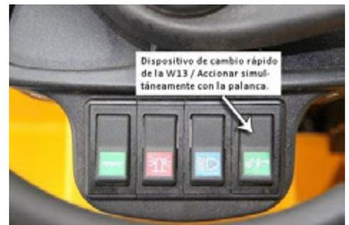
Función especial de la Eurotrac W13: además de la palanca del dispositivo de cambio rápido, al mismo tiempo debe pulsarse el interruptor del dispositivo de cambio rápido.
