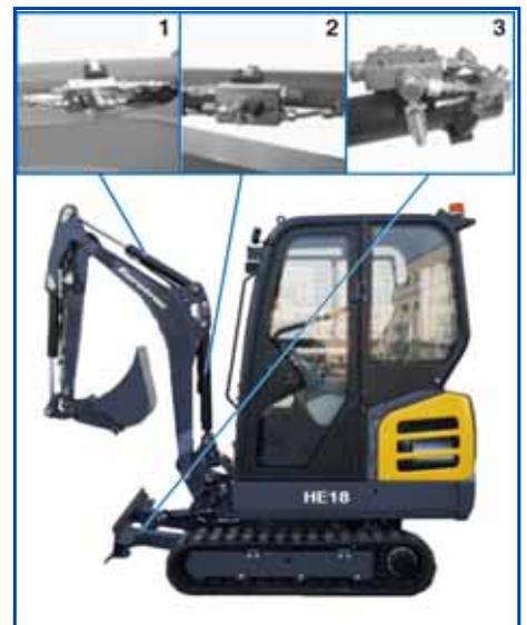
En cas d'utilisation de la lame de terrassement comme support, une protection supplémentaire d'éclatement de conduite doit être posées selon EN 474-1 pour augmenter la stabilité de la machine.
